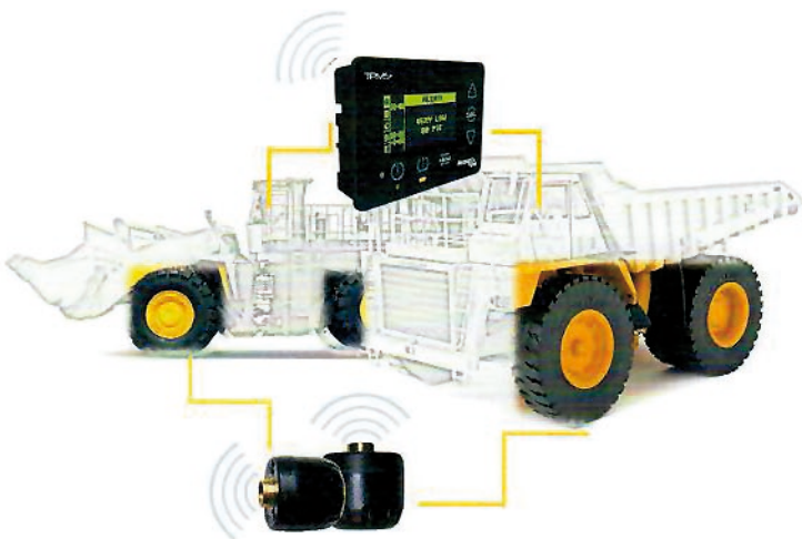
Funktionsweise des automatisierten Reifendruckkontrollsystems.
