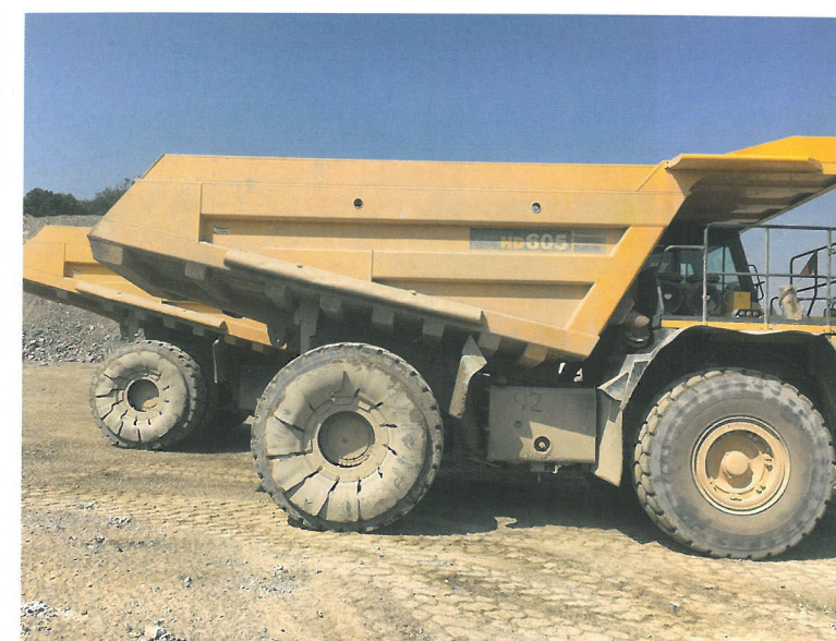
ALTERNATIVE: Der Sideflex-Schutz ist einfach an der Nabe des Rades montierbar. Foto: Rud/Erlau
