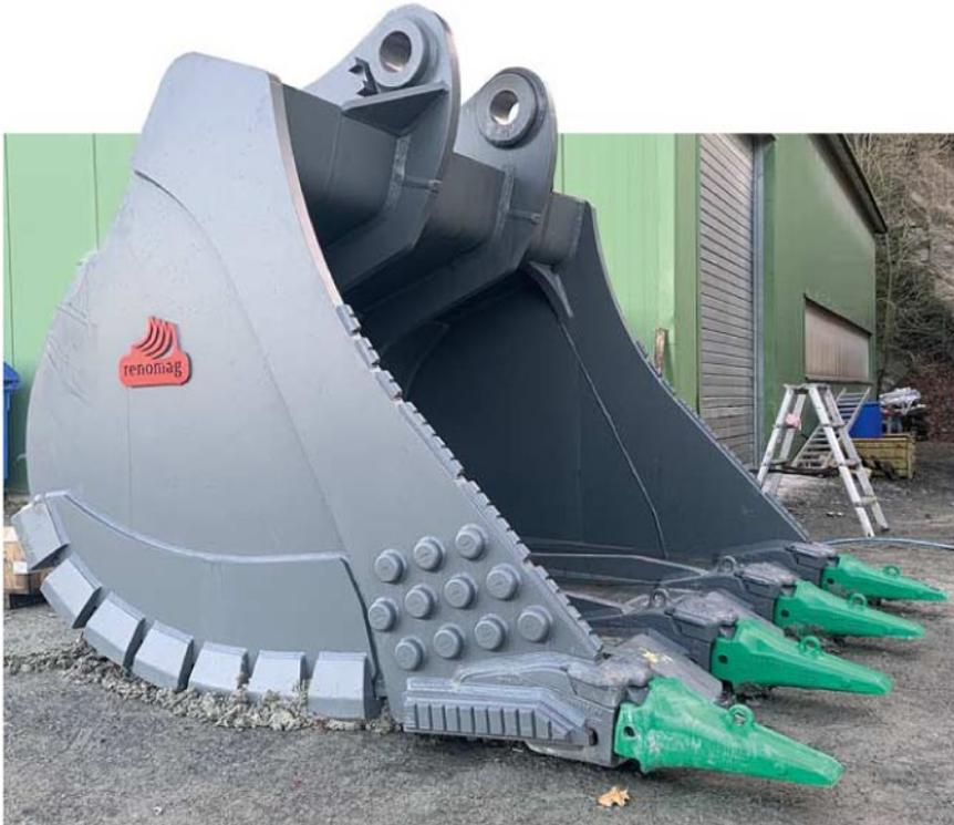
5,2 m<sup>3</sup> fassender Renomag-XXHD-Löffel mit Kugelbahn und Esco-Zahnsystem.
